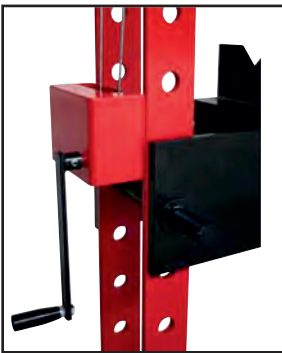
Wciągarka do podnoszenia stołu roboczego
